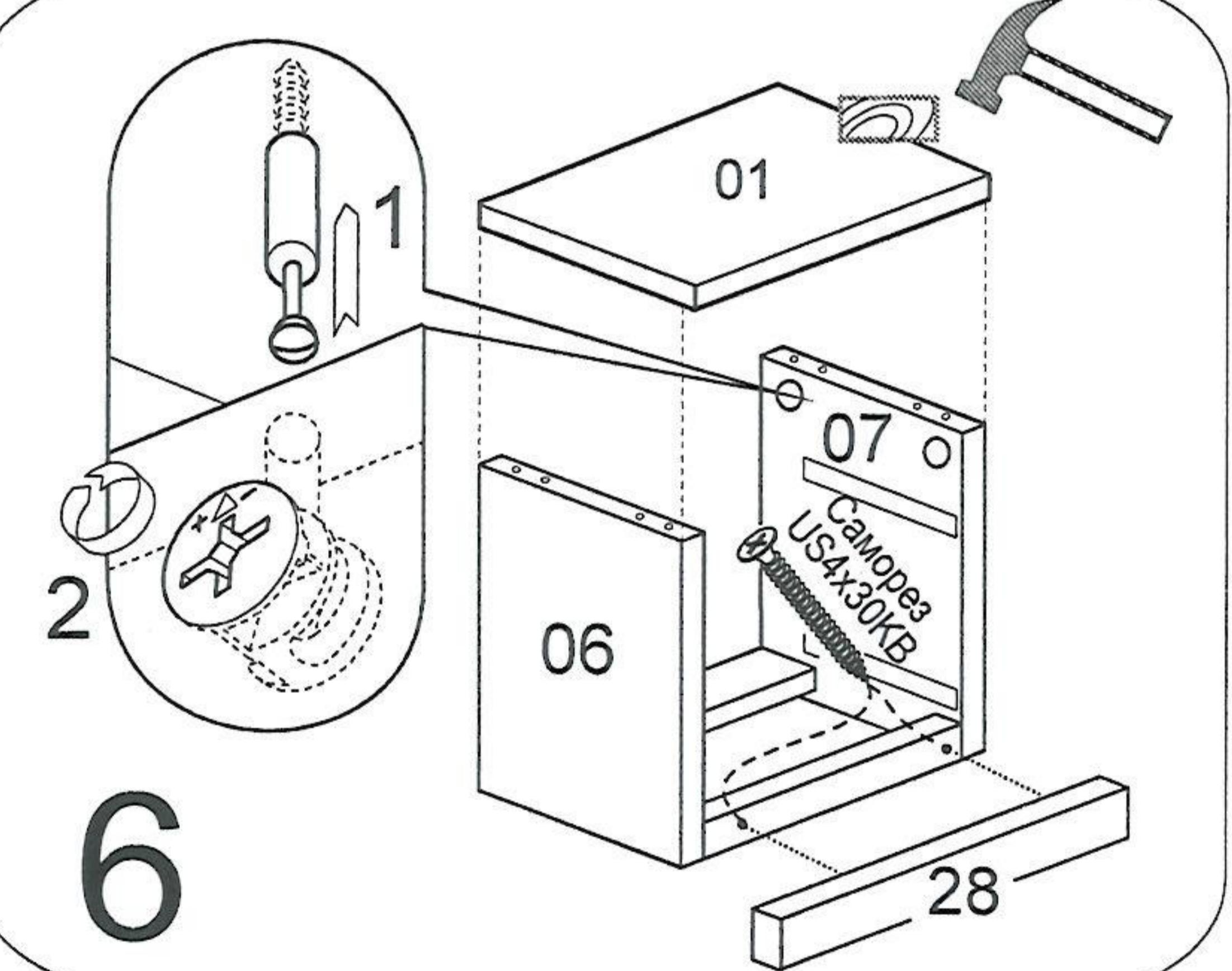
Монтируем ящики, затем выровнив корпус (он может быть ромбовидный) по стрелке, прибиваем заднюю стенку.
